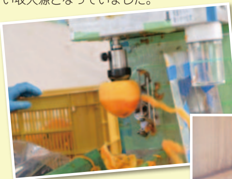
真空吸引式の 半自動柿むき機
