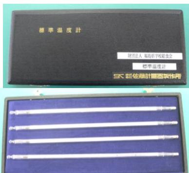
標準温度計は、基準温度計と定期的に比較構成して現場で使用する**各種温度計のチェック用**にご活用ください。
