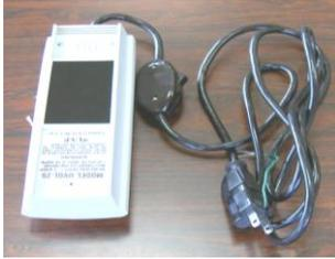
食器の**残留脂肪を検査**するために使用します。食器にクルクミン溶液をゆきわたらせ、水で軽くすすいだら、暗室等暗いところで紫外線ランプを照射し、残留脂肪を判定します。
