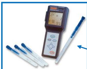
調理場内の設置機器や調理器具、手指等の汚れ度を、拭き取りによって簡単に判定できる機械です。結果は10秒で判るので、その場で衛生状態の指導が容易にできます。拭き取りには専用キット（ルシパック：検査試薬）が必要です。
