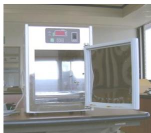
細菌や真菌類の培地を培養するのに使用します。温度調節が可能で、培地を重ねて培養できるので寒天培地やフードスタンプ、手形培地にも適します。
