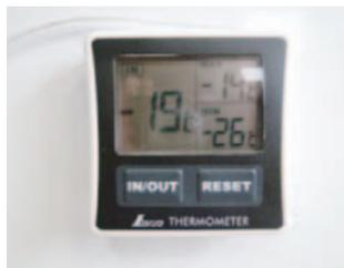
最低最高温度計とは、ある期間、たとえば1日における最高と最低の温度を測る温度計である。これを用いることにより、夜間や休業中等における、自然災害等による停電時に、冷蔵及び冷凍設備内の温度の推移を把握できる。
