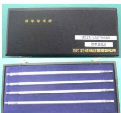
標準温度計は、基準温度計と定期的に比較構成して現場で使用の各種温度計のチェック用にご活用ください。
