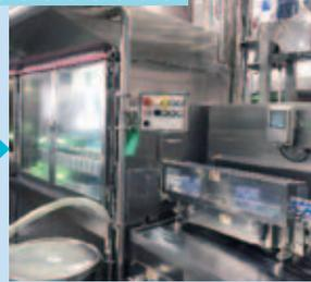
殺菌された生乳は、一時貯蔵された後、容器容量に合わせて充填包装機で充填密封され、賞味期限を印字します。
