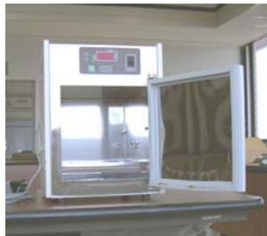
細菌や真菌類の培地を培養するのに使用します。温度調節が可能で、培地を重ねて培養できるので寒天培地やフードスタンプ、手形培地にも適します。
