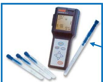
調理場内の設置機器や調理器具、手指等の汚れ度を、拭き取りによって簡単に判定できる機械です。結果は10秒で判るので、その場で衛生状態の指導が容易にできます。拭き取りには専用キット（ルシパック）が必要です。
