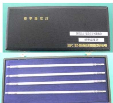
標準温度計は、基準温度計と定期的に比較構成して現場で使用的各種温度計のチェック用にご活用ください。
